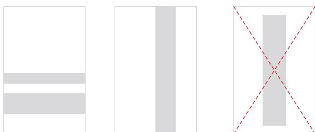
Ornament liniowy jest frezowany tylko i wyłącznie na całej szerokości lub wysokości elementu - od krawędzi do krawędzi, przy czym jedna z nich jest początkiem wzoru, a na krawędzi końcowej wzór może być ucięty.
