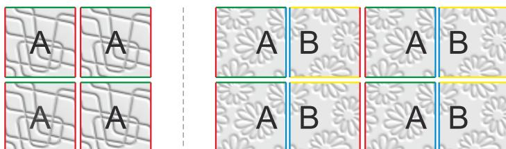
Łączenie modułów podstawowych A i AB w sposób przedstawiony na schemacie zapewnia kontynuację wzoru.
