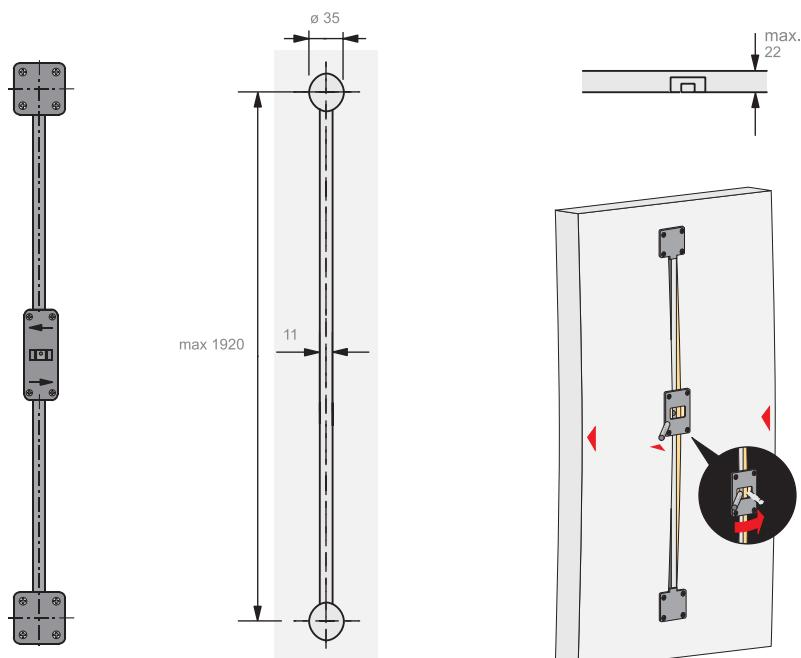
Zalecane jest zastosowanie okucie wyrównujących przeciwko wyginaniu się drzwi (wielkość do 2500mm). Montaż okucia wymaga podfrezowania pod puszki na głębokość 13 mm i pod prowadnicę na głębokość 8 mm. Zaleca się stosowanie dwóch okucia na każde drzwi. Maksymalna grubość elementu 22mm.
