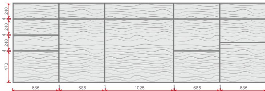
Przykładowy podział według dostarczonego projektu. Poszczególne elementy obrobione na gotowo z zachowaniem ciągłości wzoru.
