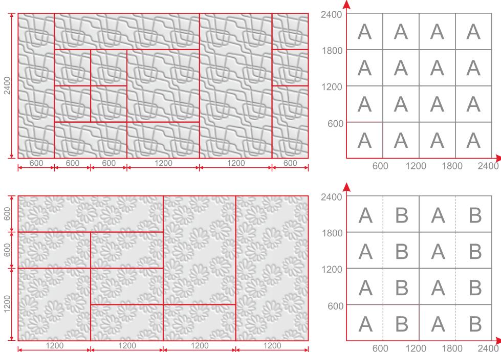
Łącząc elementy o wymiarach modułu podstawowego, a także jego wielokrotności automatycznie uzyskujemy kontynuację wzoru. We wzorach AB zwróć uwagę na przemienność.
